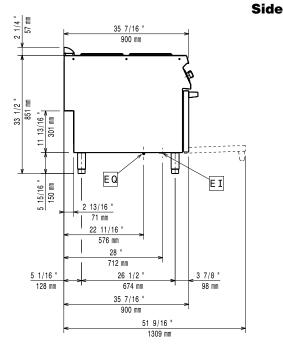
Electrical inlet (power) Equipotential screw EQ
